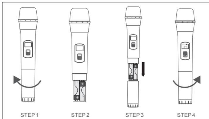
**Avis :** 1. S'il y a du bruit, de la distorsion, des points morts lors de l'utilisation du système, cela peut être dû à des piles faibles, veuillez les remplacer par des piles neuves. 2. Après l'avoir utilisé, mets l'interrupteur sur OFF. 3. Si tu n'utilises pas ce système pendant une longue période, retire les piles. Fonctionne avec 2 piles AA 1,5 V (non incluses) à insérer dans le compartiment à piles en respectant la polarité.
