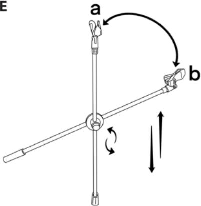
Allentare l'altra vite (6) per regolare l'altezza dell'asta che sostiene il microfono.
