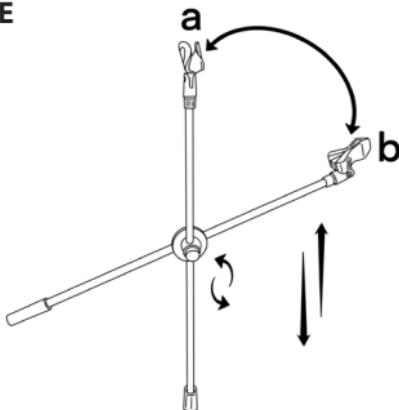
Aflojar el otro tornillo (6), para ajustar la altura de la vara que sustenta el micrófono (5). Colocar uno de los dos ganchos para micrófono incluidos (a, b) en la punta de una de las varas (los ganchos son intercambiables).
