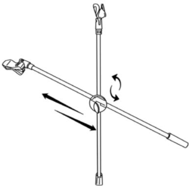
Allentare la vite (6) per aggiustare l'angolo di inclinazione e la posizione dell'asta (5) che sostiene il microfono. Dopo questa operazione stringere nuovamente la vite (6).
