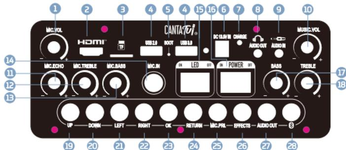
**1. MIC VOL:** utilizzare questa manopola per regolare il volume del microfono. Girare a sinistra per abbassare il volume, a destra per alzarlo.
